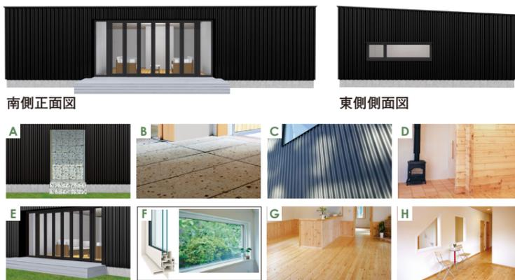
[A. 玄関デザイン] 大谷石貼りのエントランス。大波ガルバ外壁との相性抜群。[B. 大谷石] ナチュラルで柔らかいテイストの大谷石。[C. 大波ガルバ] ガルバリウム鋼板製の波大波ガルバ外壁。ゆるやかなサインカーブモダン。[D. ログの装飾壁] ログの装飾壁はbbオリジナル。棚や壁掛テレビの役目もかね、ログの香りは心を癒し、健康増進に最適です。[E. リビング大開口] 3.5mのワイド折戸でリビングからの大開口空間がベランダへ繋がります。とても贅沢な空間を演出します。[F. 超断熱サッシ] 樹脂+Lowガラス-E複層ガラスがアルゴンガス封入で、国内最高レベルの断熱性能を実現。結露の心配なし。[G. バインのフローリング] bbの専売特許。無垢板のレッドバインフローリング。[H. ホワイトウォール] モダンデザインの必須アイテム。白い壁が明るく清潔で気持ちいい空間を演出。OPで塗壁も可能。
